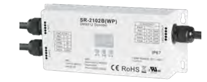
SR-2102B Decodificador protocolo DMX512 para luminarias RGBW
