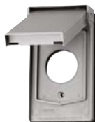
Placa intemperie para receptáculo sencillo; 35mm de diámetro (1.41") 4979-GY
